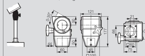
Pied fixe réf. 0 357 64 muni d'un raccord adaptateur d'inclinaison
