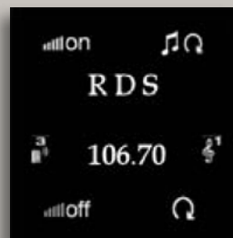
Écran tactile 1,2" configuré pour la gestion de la diffusion sonore
