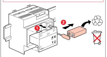
Certains modèles d'accumulateurs qui équipent cette télécommande contiennent du cadmium ( batterie Ni-Cd ) pouvant être dangereux pour l'environnement. Les distributeurs partenaires LEGRAND reprennent ces accumulateurs usagés.
