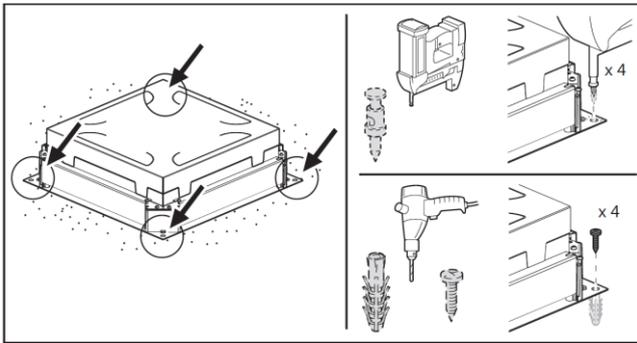
2) Mise en place des conduits avant le coulage de la dalle
