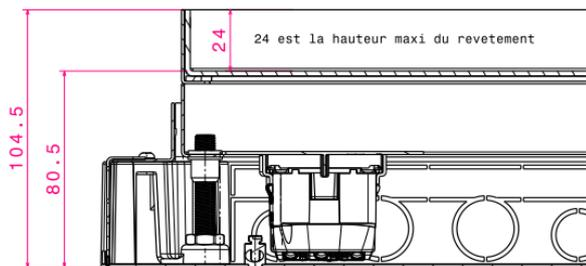
Hauteur béton mini 80.5 si revêtement ( carrelage + colle) = 24 mm.
