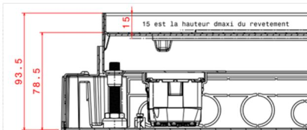
Hauteur béton mini 78.5 si revêtement ( carrelage + colle) = 15 mm.
