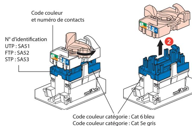
Ce système permet d'épanouir facilement les paires avant montage sur le connecteur.
