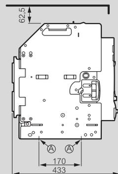
A = points de fixation sur la platine de montage
