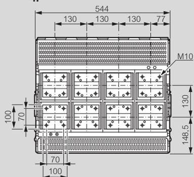
Prises arrière pour raccordement horizontal
