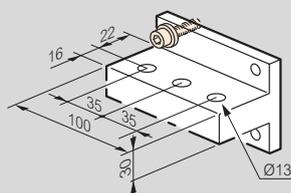
Prises arrière pour raccordement vertical
