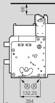
A = points de fixation sur la platine de montage
